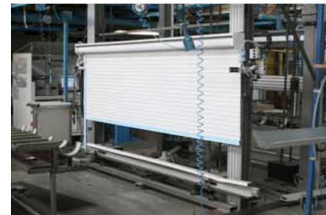
Banc de montage et d'essai pour vérification de l'aspect et du nombre de lames avec test et réglage de fin de course moteur.
