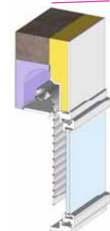
Coffre Tunnel demi linteau
