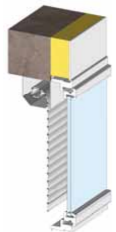
VR Rénovation enroulement extérieur
